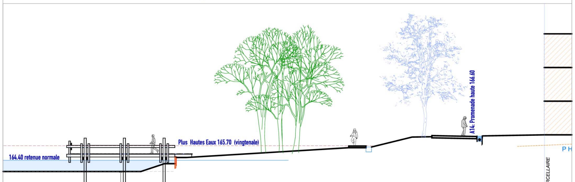
Coupe sur ponton et promenade haute Hors échelle
