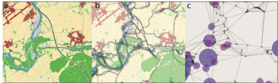
Fig.2 : Modélisation des réseaux écologiques par la théorie des graphes. À partir d'une carte de paysage (a), les taches d'habitat et les chemins de moindre coût sont identifiés (b). Le graphe sert ensuite de support au calcul de métriques de connectivité (c) afin de hiérarchiser les éléments en fonction de leur importance.
