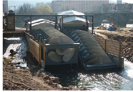
(b) La vis d'Archimède (source : ONEMA).
