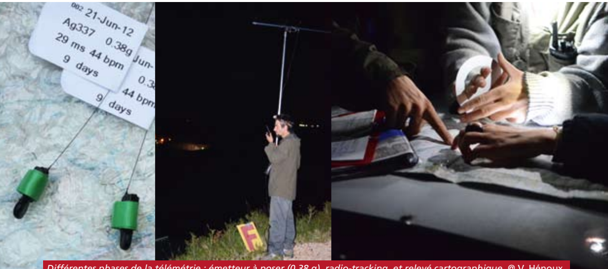
Différentes phases de la télémétrie : émetteur à poser (0,38 g), radio-tracking, et relevé cartographique. © V. Hénoux
