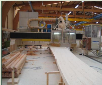
Centre de taillage numérique 42,00 X 7,50 m
