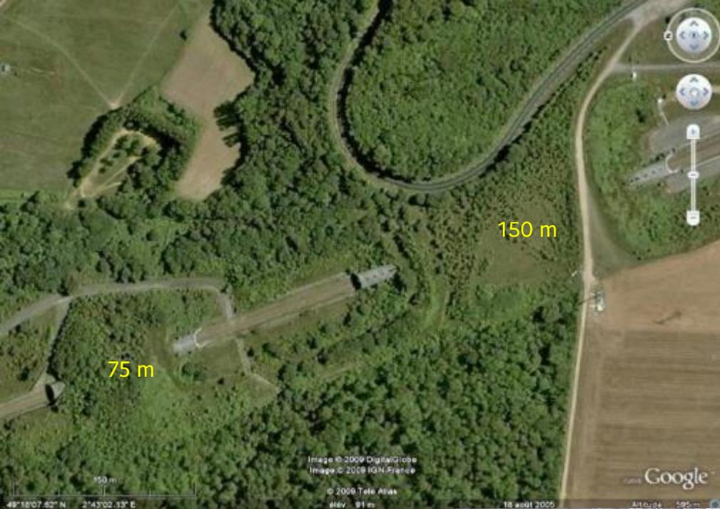
LGV Nord : en plus de la réalisation d'une tranchée couverte pour la faune de 80 m de largeur, deux autres tranchées couvertes ont été réalisées pour des raisons paysagères dans la descente du coteau de l'Oise cumulant 225 m ! Ce qui est peu connu...
