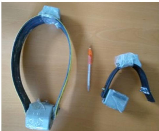
Figure 16 : Colliers GPS utilisés dans l'étude (à gauche collier pour sanglier, à droite un collier pour chevreuil).
