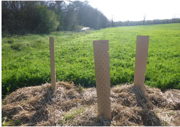
Test de gaines de protection biodégradable
