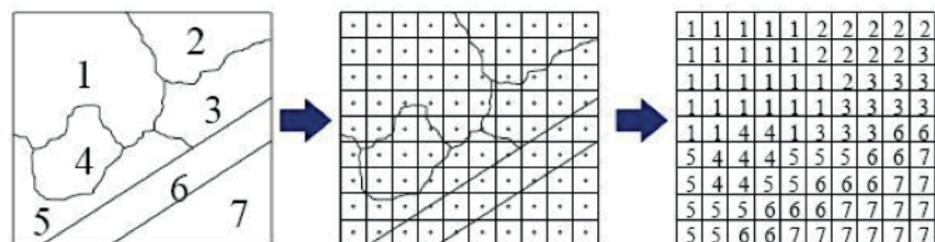
Fig.2 : Principe de la rasterisation (conversion du format vecteur vers le format raster) source : Univ Saint-Etienne
