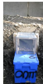
Dispositif de collecte en sortie d'ouvrage
