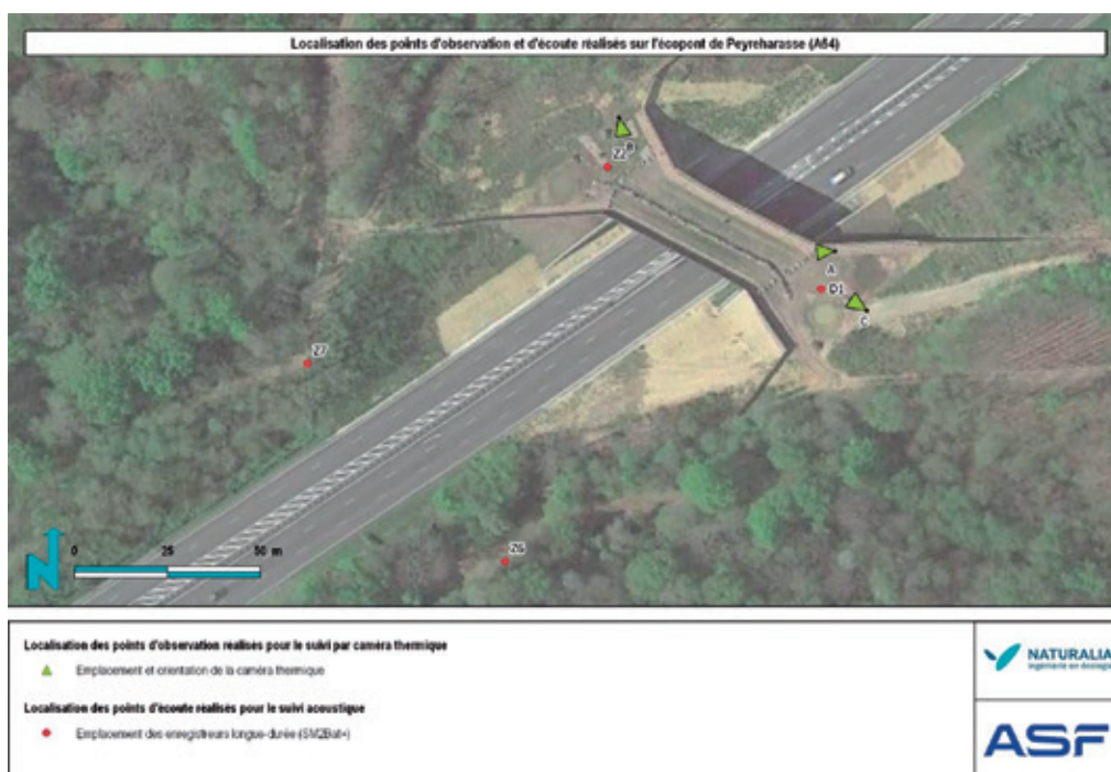
Figure 7: Localisation des points d'observation (caméra thermique) et d'écoute (SM2Bat+) réalisés sur l'écopont de Peyreharasse (A64)
