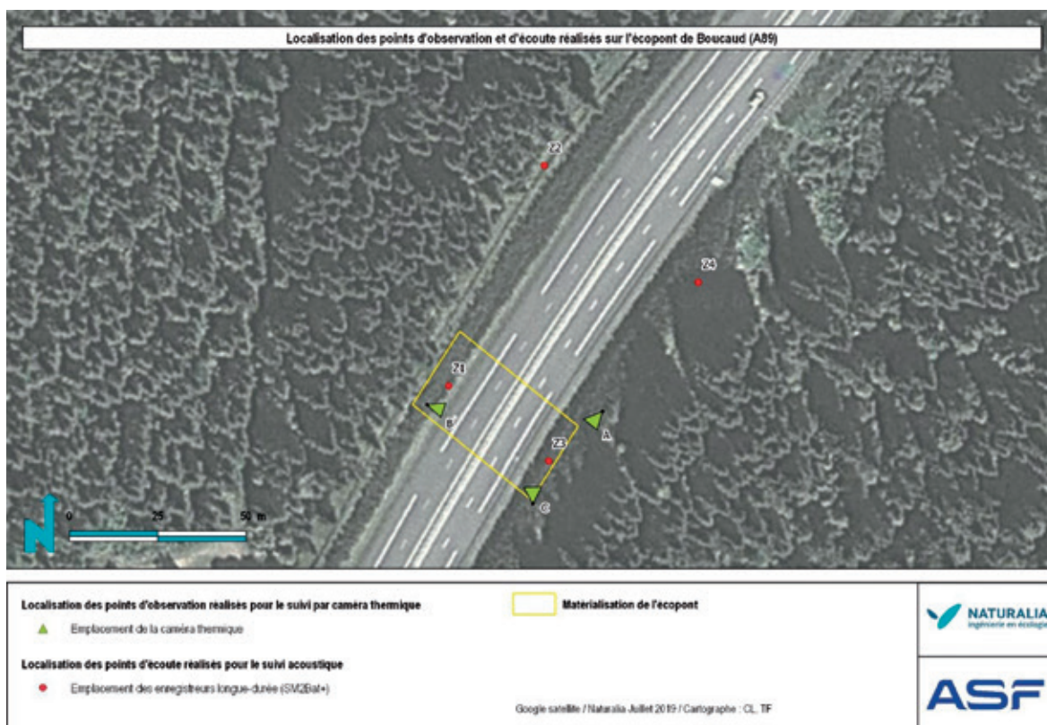
Figure 8: Localisation des points d'observation (caméra thermique) et d'écoute (SM2Bat+) réalisés sur l'écopont de Boucaud (autoroute A89)
