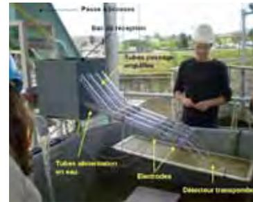
Compteur électronique ELFES-ELTA : capteur installé à l'amont de la passe à anguillettes de Golfech.
