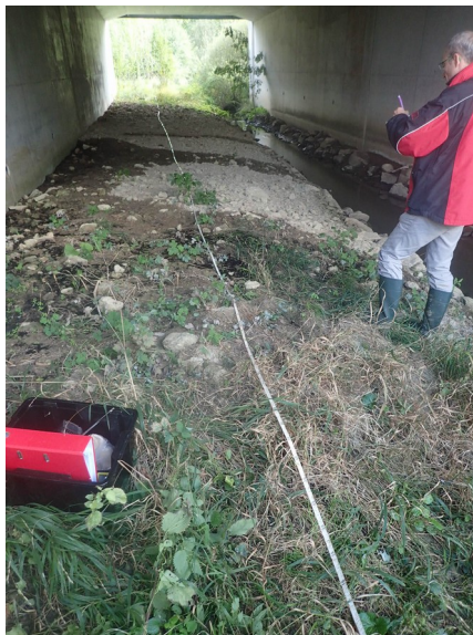
Figure 7 : Exemple de mise en œuvre de la méthode de relevés de terrain (décamètre placé dans l'axe, un bâton permet de relever où chaque classe de recouvrement « s'enfonce » au maximum sous le PI* (Cerema : A. Morand - Cerema Est)
