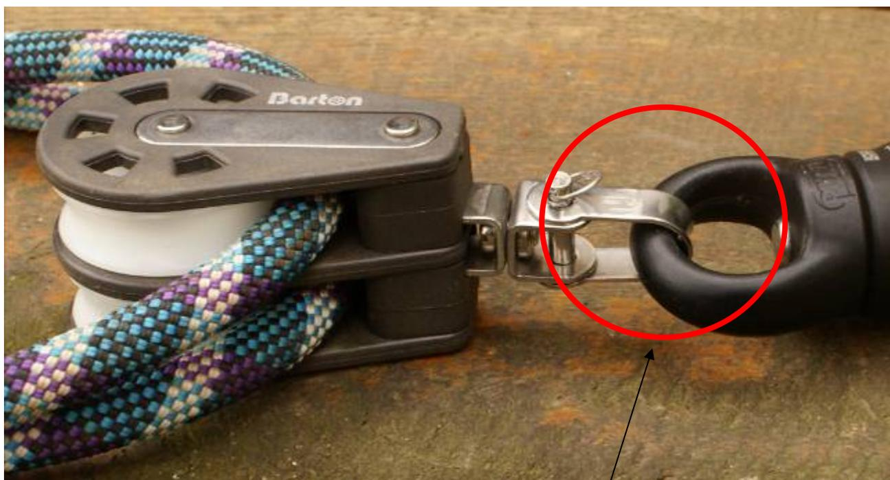
Cet émerillon de poulie, deviendra inefficace sous forte tension. D'où la nécessité impérative de rajouter un émerillon à bille.
