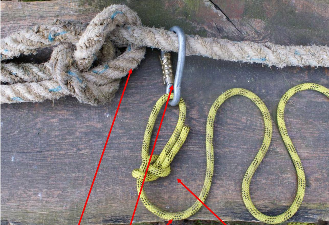
L'avantage du nœud de chaise, c'est qu'il permet la libre rotation de l'écuroduc sans risque d'accroche avec le cordage de sécurité (grâce à ça boucle arrondie)
