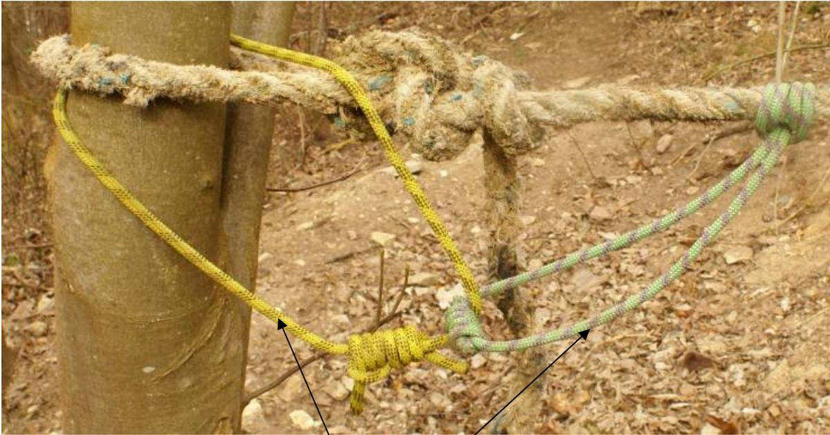
Le cordage de sécurité ne doit pas être sous tension, il doit rester « mou » et détendu.
