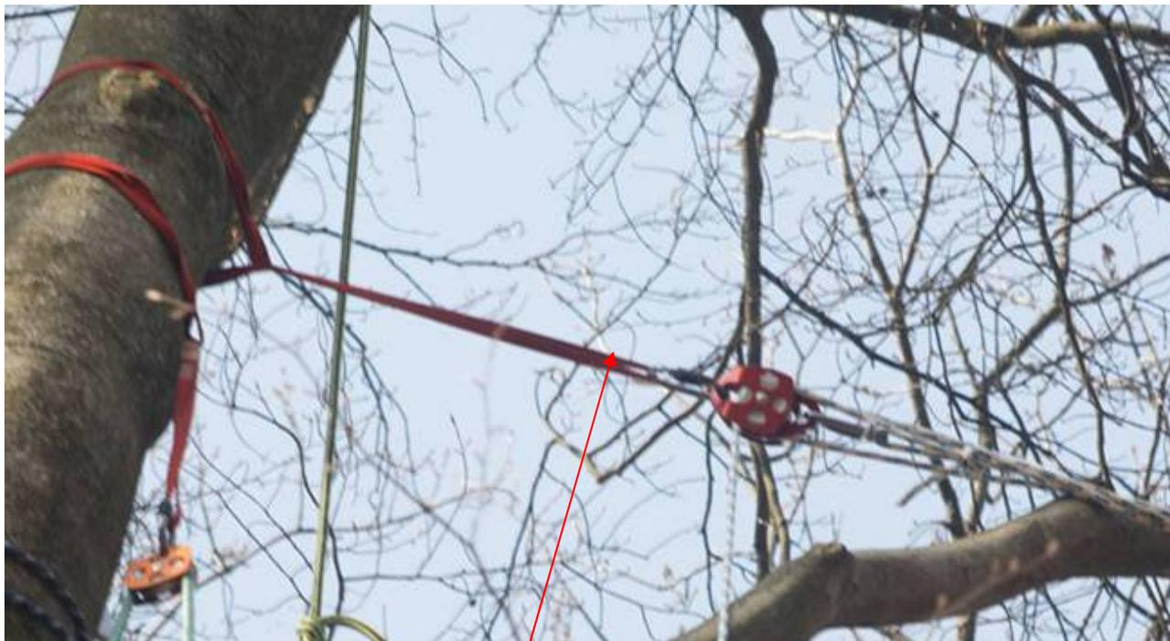
Le palan peut être raccordé soit par une sangle de grimpe, soit par un cordage avec 2 tours morts reliés par un nœud de grinner double
