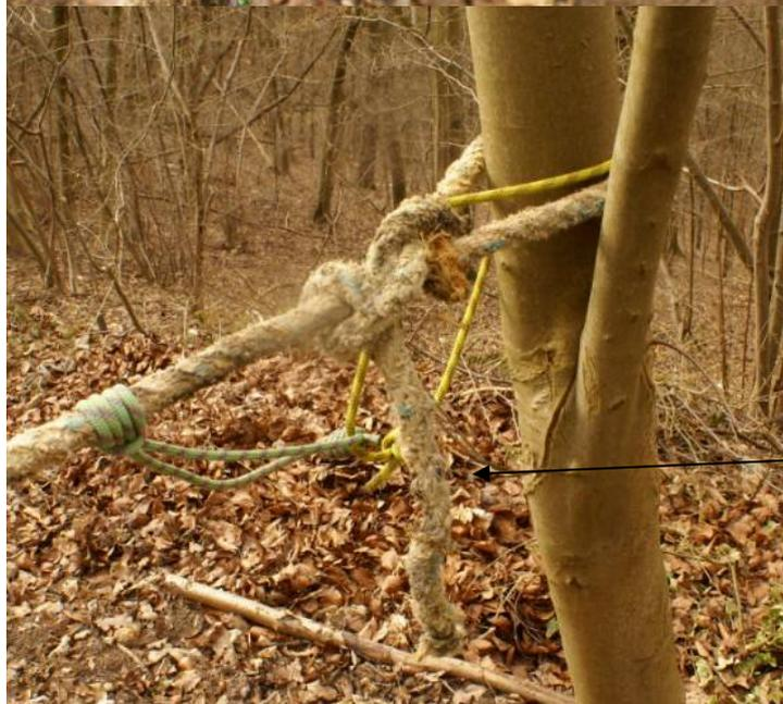
Nœud d'amarrage 2 demi-clé : Permet de reprendre le réglage de l'écuroduc sous tension.
