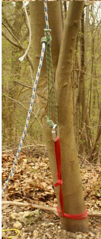
e) Détail de la partie palan se raccordant à l'arbre (Zone 4).
