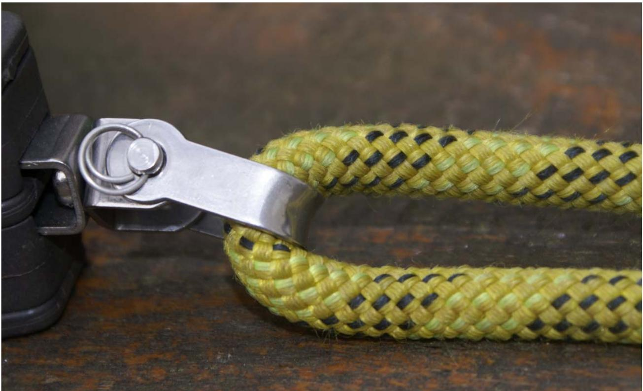
Risque de coupure => montage interdit
