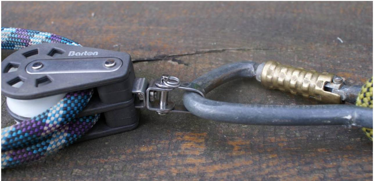
Les poulies équipées d'un anneau plat interdisent tout montage direct avec une corde (risque de coupure). Dans ce cas, il est impératif de monter un mousqueton ou un maillon rapide. Inconvénient de ce montage, le métal contre métal peut engendrer des usures prématurées.
