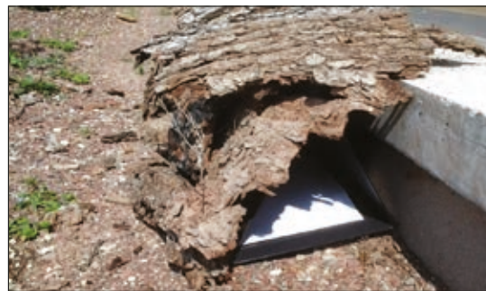
Photo n°33 : Piège à encre sur un écopont de l'A57. (©CEN PACA).
