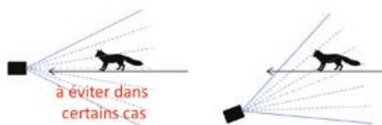
Figure n°20 : Vue aérienne du placement optimal théorique pour le Reconyx dans des ouvrages de faible largeur.
