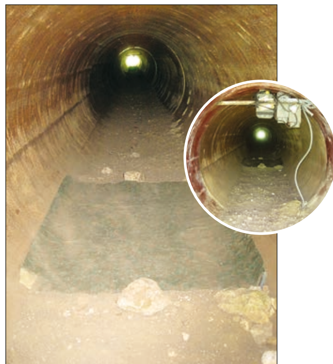
Photo n°98 : Système de piège photographique à capteur de vibration (tapis) mis en place dans un écoduc de l'A10. (© LPO France, VINCI Autoroutes).
