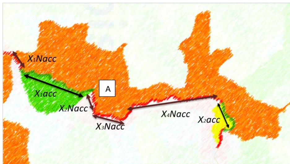
Figure 24: Schéma explicatif du principe de calcul du pourcentage de contiguïté pour la zone de réservoir A
